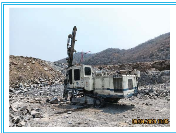
รูปที่ 3-7 เครื่องเจาะระเบิดที่มีอุปกรณ์เก็บฝุ่นติดไว้กับหัวเจาะ
